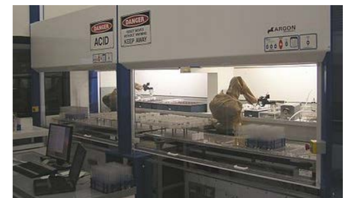
Ảnh: Robot Argon hoạt động trong môi trường axit
