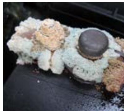
Ốc quy bị oxy hóa do sử dụng lâu ngày
