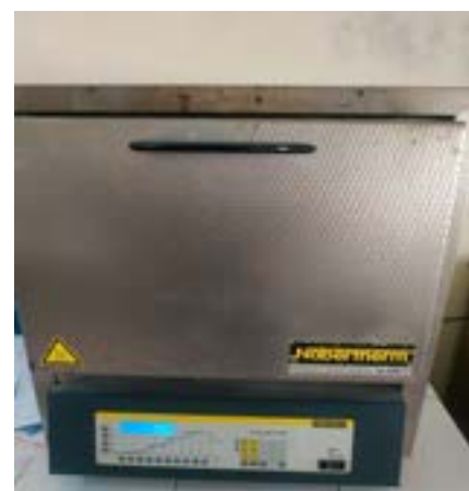
Hình 2: Lò nung nhiệt độ cao sử dụng trong thí nghiệm nung phân hủy kiềm NaOH và KOH tinh quặng monazit Việt Nam Trước khi tiến hành nung phân hủy, tinh quặng monazit được xác định các đặc tính pha tinh thể bằng XRD và thành phần hóa học bằng các ICP-OES.
