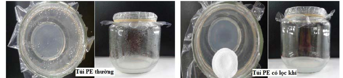
Hình 1: Bình nuôi cấy không thoáng khí (bịt bằng túi PE thường) và thoáng khí (bịt bằng túi PE có lọc khí).
