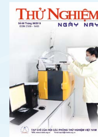
Ảnh bìa: Thực tập sinh người Pháp sử dụng Máy Gerhardt dumatherm dùng để phân tích nitro tổng số trong phân bón tại Phòng thử nghiệm VinaCert. (Ảnh: Thanh Hải)
