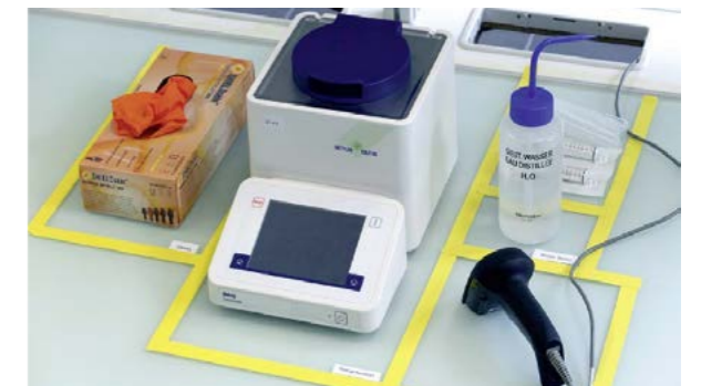
Hình 7: Một nơi làm việc điển hình trong một phòng thử nghiệm tinh gọn của một khách hàng lớn. Các dấu màu vàng trên bảng phòng thử nghiệm cho thấy vị trí chính xác của vật liệu làm việc và vị trí nơi nó có thể được tìm thấy. Nhờ những sắp xếp tốt đẹp và tiêu chuẩn hóa, ngay cả nhân viên từ các khu vực khác cũng có thể nhanh chóng tìm thấy đường đi của chúng
