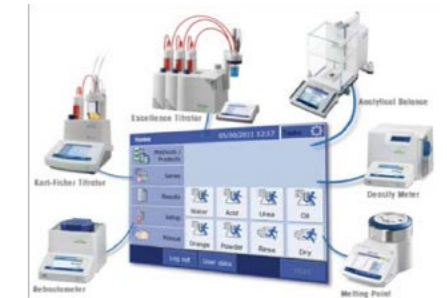
Hình 2: Giao diện thông thường (màn hình cảm ứng) cho một số thiết bị phân tích: Chuẩn độ, Karl Fischer, mật độ, khúc xạ, điểm nóng chảy, điểm giọt, đo pH, cân bằng, spektrophotometer UV / VIS
