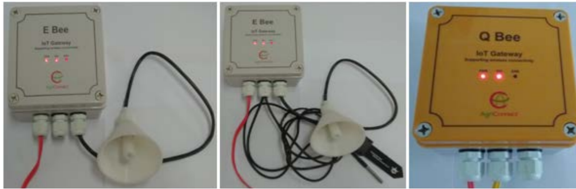
Hình 2.1: Thiết bị cảm biến của AgriConnect- ghi nhận nhiệt độ, ẩm độ không khí, nhiệt độ và ẩm độ đất
