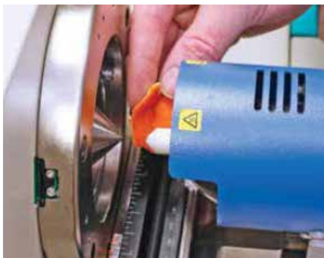
Direct Analysis in Real Time (DART) trên hệ thống AccuTOF-DART của JEOL sẽ nhanh chóng kiểm tra lượng thuốc diệt nấm trên vỏ cam. BẢN QUYỀN HÌNH ẢNH CỦA JEOL
